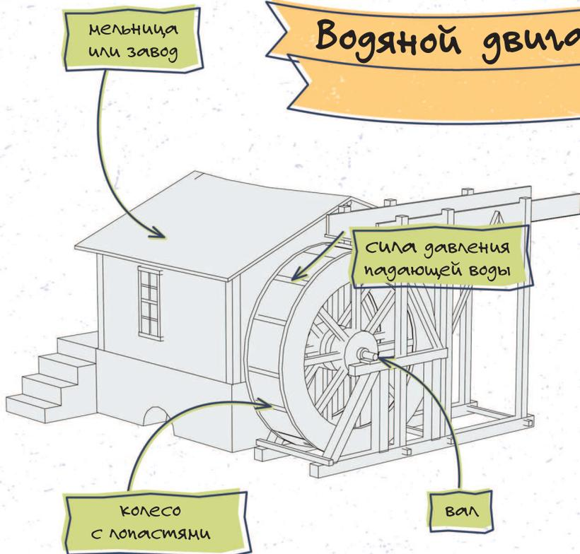
В результате множества технических усовершенствований в Средние века появились более эффективные водяные двигатели, колеса которых вращались за счет действия массы падающей на них воды. Диаметр таких колес мог достигать 10 м. Однако даже такие моторы могли обеспечить скорость вращения лишь немногим более 10 об./мин. Кроме того, они использовали менее половины энергии воды, и их мощность редко превышала несколько десятков лошадиных сил (л. с.).
