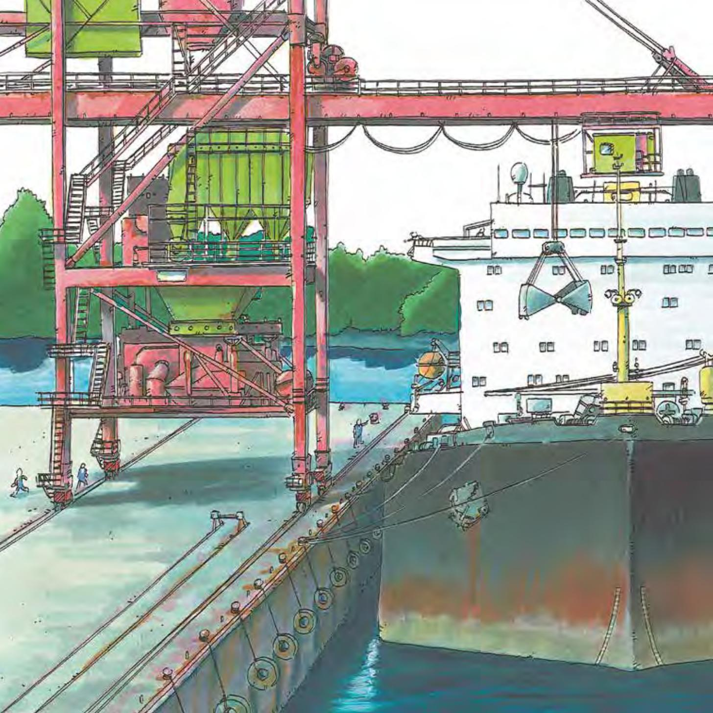
Потом мы проплываем мимо балкера. Так называются суда, которые перевозят насыпной груз: зерно, корм для животных или руду. Разгружают такие корабли с помощью специального захвата, грейфера, или больших труб, которые как огромные пылесосы высасывают зерно из трюма корабля и перемещают в специальные цистерны, зернохранилища.
